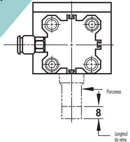
El cilindro de aire puede ser desmontado y montado a 90° o 180° de la posición mostrada.
